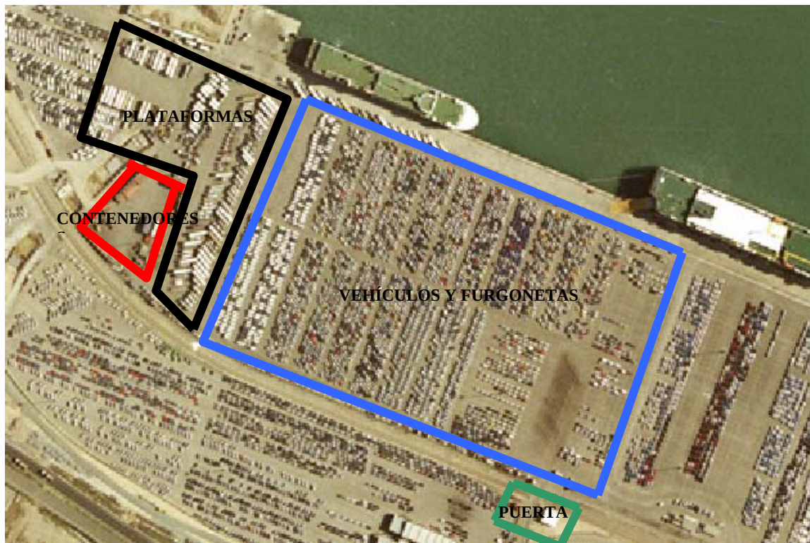
Ejemplo de distribución física de una terminal.
